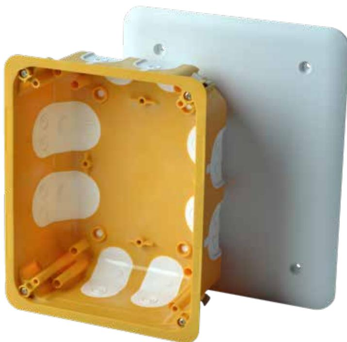
Большая распределительная коробка с большим количеством мембранных вводов для кабелей или труб. Коробка может быть оснащена клеммной колодкой S-KSK 2. Коробка позволяет установку Din-реек TS. Коробка имеет в нижней части шипы для обозначения центров сверления, что облегчает монтаж. Обозначение точек сверления дополнительно расположены также и с лицевой стороны коробки. Крышка и винты из нержавеющей стали для её фиксации поставляются в комплекте.
