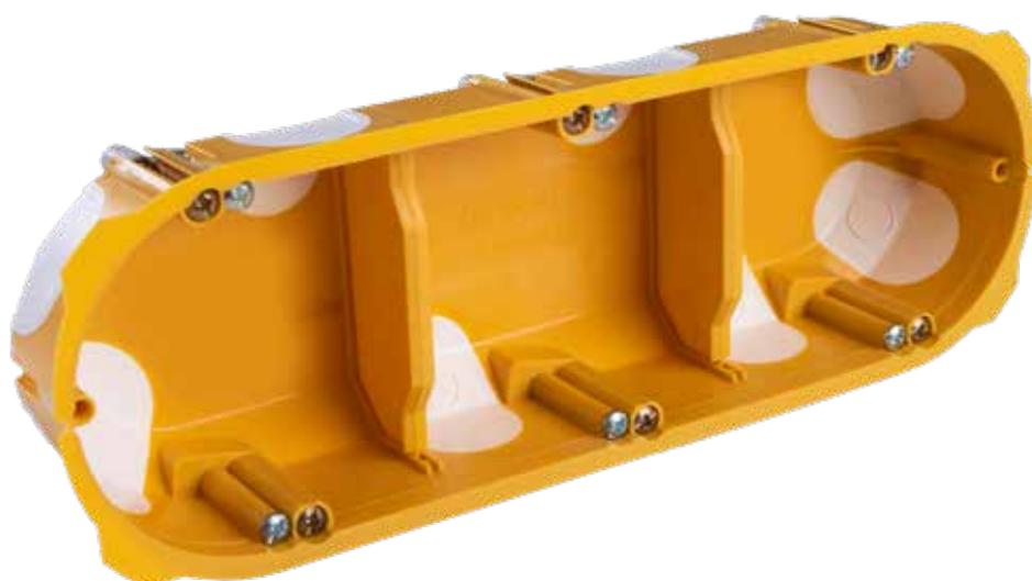
Электромонтажная коробка с уменьшенной монтажной глубиной (40мм) для установки трех приборов под единой рамкой. Коробка оснащена съемной перегородкой для возможного разделения отдельных цепей.
