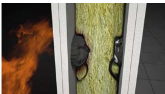
Демонстрація вогнестійкості приладової коробки.
